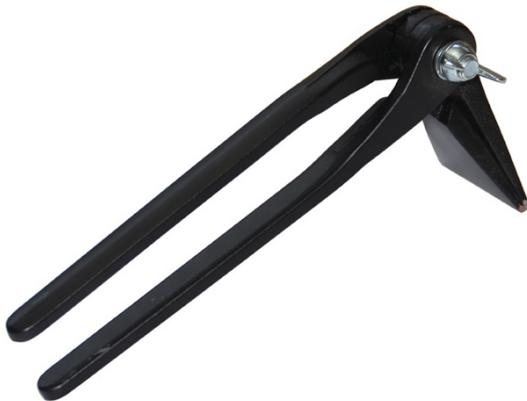
Falzzangen können verwendet werden, um verschiedene Falten für die Herstellung der Zinkarbeiten herzustellen. Die gebogene Form ermöglicht es, eine Falte in einem unzugänglichen Winkel herzustellen.
